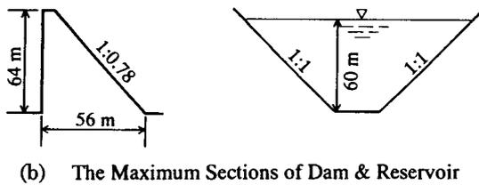
**Fig. 4 Dam-Foundation-Reservoir System**
