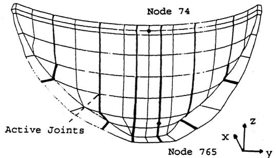
Fig.3 Ambiesta dam: finite element mesh
