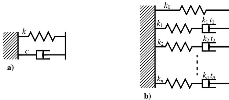
**Fig. 3 – Spring-dashpot models: a) Kelvin-Voigt (KV) model; b) Generalized Maxwell (GM) model**
