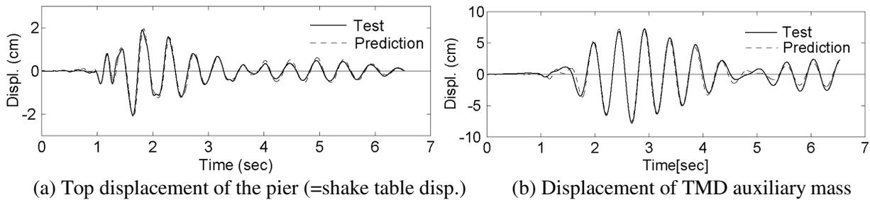
Fig. 8 Test result: Kobe JMA NS input
