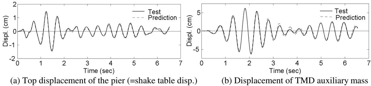
Fig. 7 Test result: El Centro NS input
