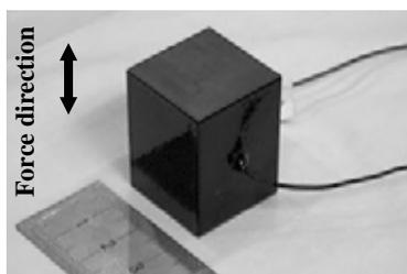
Figure 3 Piezoelectric actuator
