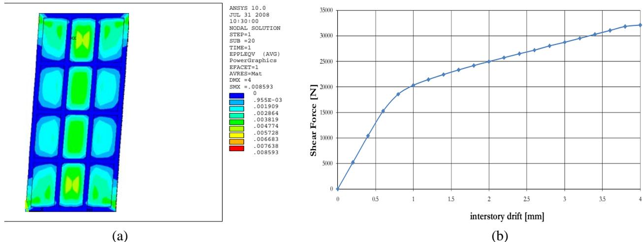
Figure 2 Aluminium - steel device with 12 windows ( $n_x=3$  and  $n_y=4$ ) and  $b_1=8\text{mm}$ ,  $b_2=40\text{mm}$ ,  $b_3=8\text{mm}$ ,  $h_1=10\text{mm}$ ,  $h_2=100\text{mm}$ ,  $h_3=10\text{mm}$ ,  $t_1=5\text{mm}$ ,  $t_2=3\text{mm}$ ,  $t_a=2\text{mm}$ : a) Von Mises strain; b) constitutive law
