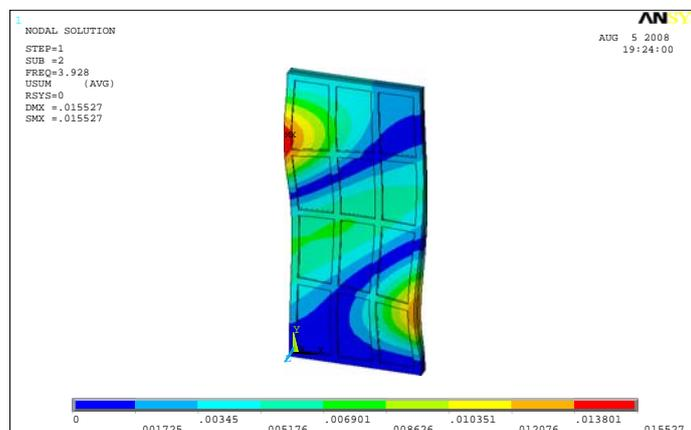
Figure 3 Buckling analysis of the aluminium - steel device with 12 windows ( $n_x=3$  and  $n_y=4$ ) and  $b_1=8\text{mm}$ ,  $b_2=40\text{mm}$ ,  $b_3=8\text{mm}$ ,  $h_1=10\text{mm}$ ,  $h_2=100\text{mm}$ ,  $h_3=10\text{mm}$ ,  $t_1=5\text{mm}$ ,  $t_2=3\text{mm}$ ,  $t_a=2\text{mm}$ .
