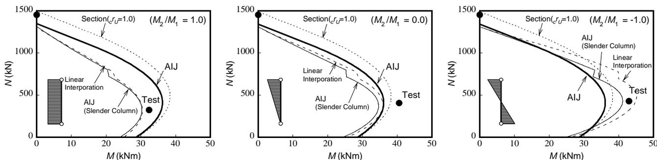
(d)  $L_k/D=10$  (Middle-length column),  $c\sigma_B=60N/mm^2$
