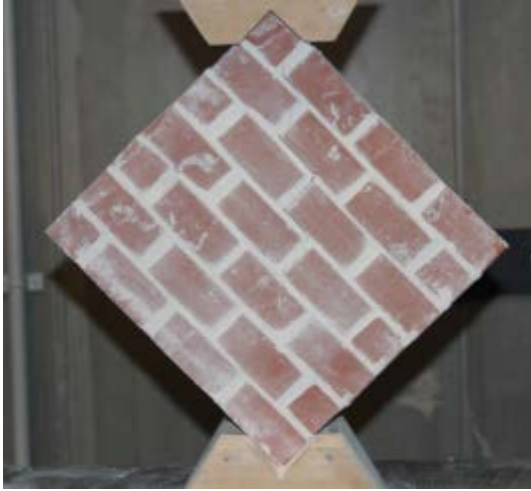
Fig. 4 – In-plane test of URM
