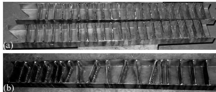
Fig. 2 – The stiffeners Configuration; a) XBF2, b) XBF3
