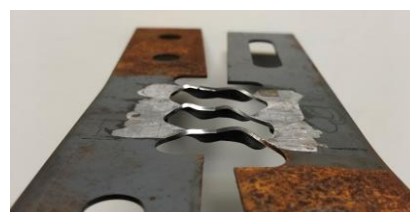
(d) Torsional buckling (C3-40-5.5)
