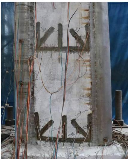
(a) Cracks on RC web
