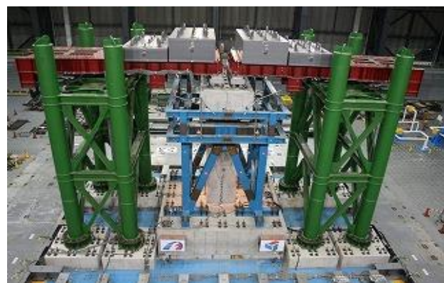
(d) Reinforced concrete bridge pier excitation test
