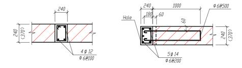
Figure 8 : Intermediate tie-columns 5
