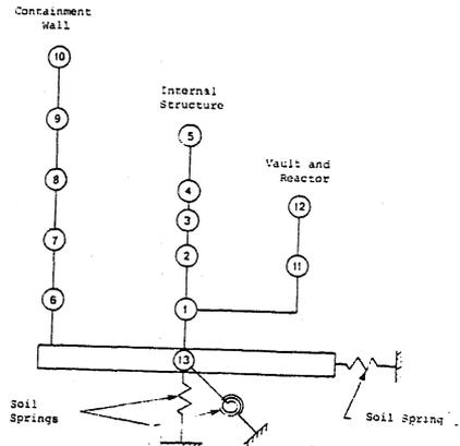
Fig. 2 CANDU 600MWe REACTOR BUILDING DYNAMIC MODEL
