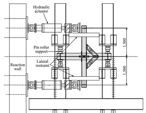
(d) Example of test setup (cruciform subassemblage)
