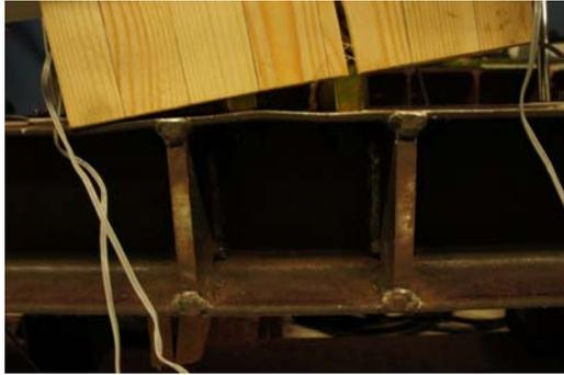
**Figure 3.7.** Plate-buckling (HB)
