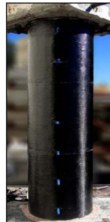
(d) CFRP repaired SP2
